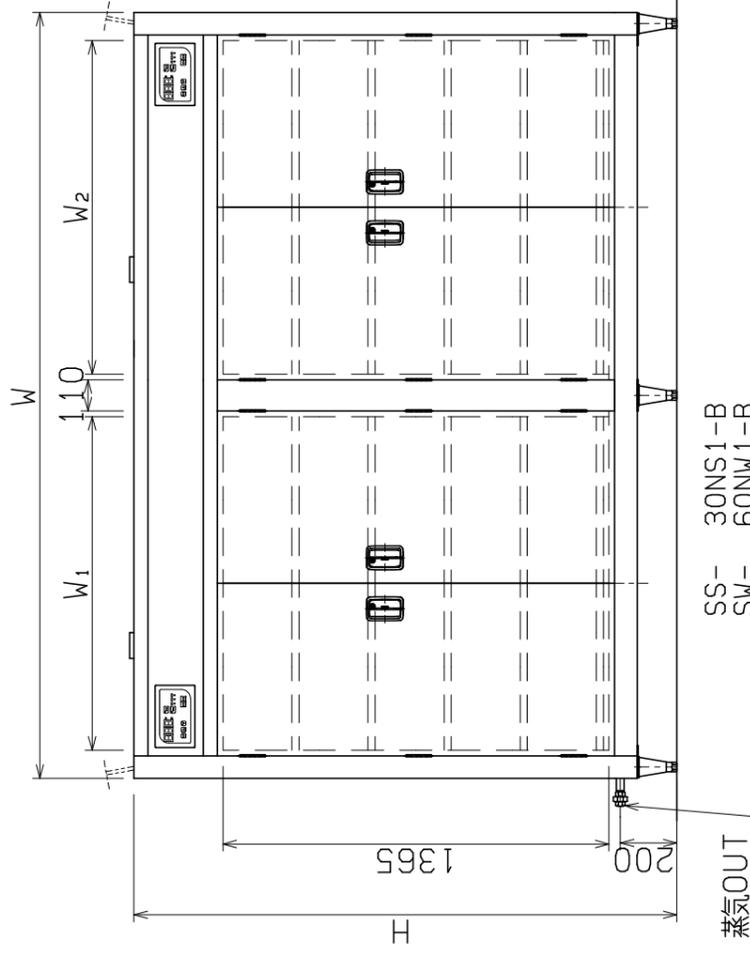
食器消毒保管庫(蒸気式100V) 高さ寸法(H)約±15mm変更可能
